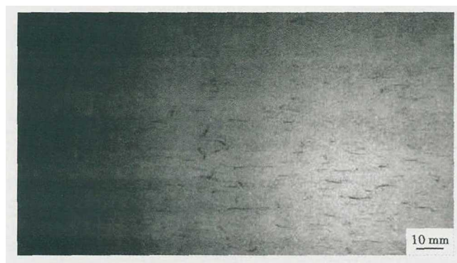
图 1 宏观裂纹形貌(钢板厚度 40 mm)
